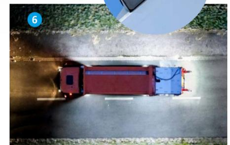
Die Rundumbeleuchtung gewährleistet eine optimale Ausleuchtung des Arbeitsraums.
