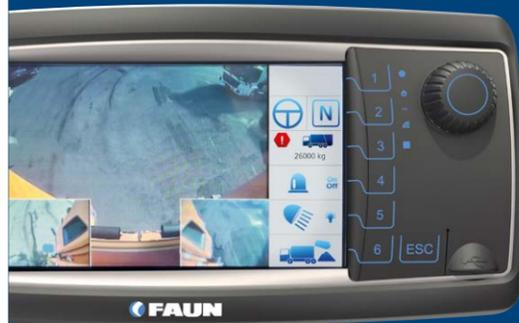
Achslastüberwachung, optional mit Abschaltung des Behälterantriebes möglich
