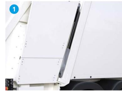
Seitlich angebrachte Heckteil-Öffnungszylinder, optimal vor äußeren Einflüssen geschützt. Im unbetätigten Zustand eingefahren.
