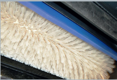
Glykol-Absaugvorrichtung im Kehrwerk integriert
