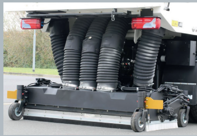
HD-Balken am Kehrwerk
